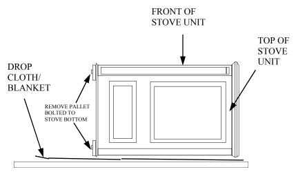
FIGURE 7 - LAYING DOWN STOVE ON SIDE
