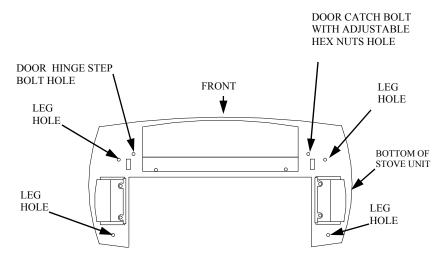
FIGURE 8 - LOCATING THREADED HOLES FOR STOVE BOTTOM, LEGS
