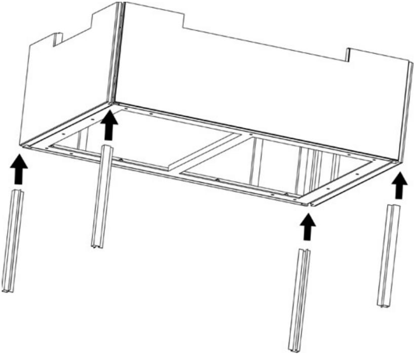
**Insérer les inserts de renforcement du socle**
