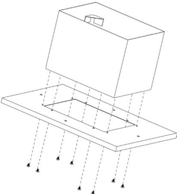
**Step 28** **Attach chimney assembly**
