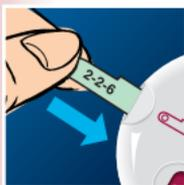
2. Con el Medidor apagado, sostenga el extremo redondo de la Tira de Prueba, e introdúzcala completamente dentro del Medidor. Usted oír un "bip".
