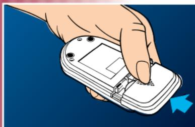
1. Usando el dedo pulgar, oprima firmemente en la flecha para abrir el compartimento que contiene las baterías. Empuje hacia adelante para sacar la tapadera.
