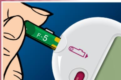
2. Introduzca la Tira de Codificación en la ranura para la prueba, como se muestra. Suena un "bip", y un despliegue de pantalla completa aparece brevemente. Suena otro "bip" y el Número de Código (por ejemplo F-5) aparece en la pantalla.
