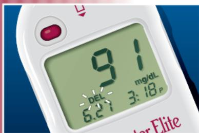
***Para Borrar un Control:*** Oprima el botón y sostenga hasta que "CONT" aparezca en la parte superior de la pantalla. Suelte el botón y "CONT" aparece en forma intermitente. Oprima de nuevo el botón, "DEL" aparece en forma intermitente, arriba de la fecha. Saque la Tira de Prueba mientras "DEL" aparece en forma intermitente.
