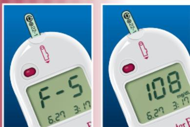
4. Para marcar la prueba como una Prueba de Control, saque la Tira de Prueba e inmediatamente vuélvala a introducir (en el término de dos segundos). Cuando "C-" y el Número de Código (F#) aparezcan en forma intermitente, usted sabrá que la prueba ha sido marcada.
