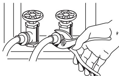
**NOTA:** No los apriete demasiado. Se pueden dañar los acoplamientos.
