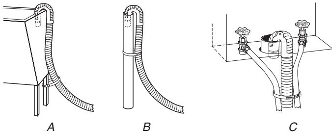
Si los grifos de la lavadora y el tubo vertical de desagüe están empotrados (vea la ilustración C), ponga el extremo en forma de gancho de la manguera de desagüe en el tubo vertical.
