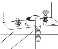
Le sommet du tuyau de vidange doit être d'au moins 30" (76,2 cm) de haut et au maximum à 96" (2,4 m) de la base de la laveuse.
