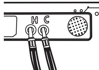
3. À l'aide d'une pince, vérifier l'étanchéité des raccords de tuyaux déjà reliés à la laveuse.
