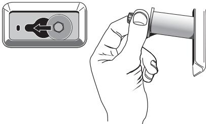
3. Une fois les 4 boulons enlevés, les jeter ainsi que les cales d'espacement. Tirer ensuite le cordon d'alimentation à travers l'ouverture du panneau arrière et fermer le trou à l'aide du bouchon joint.
